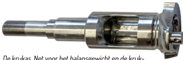
De krukas. Net voor het balansgewicht en de krukpen zit de gefreesde groef. Deze dient als loopbaan voor de achterste lagerkogels.
